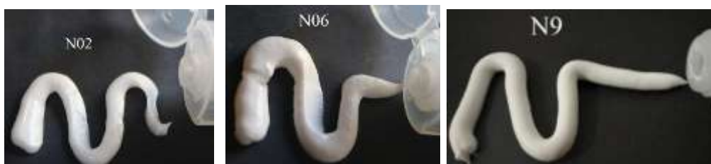
Hình 3. Kiểm tra tách lớp của sản phẩm
